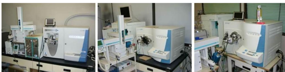
図2 イオントラップ型質量分析計 左からLTQ、LCQdeca、LCQdecaXP
