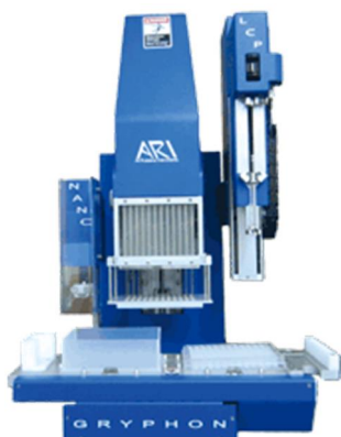
図1 蛋白質結晶化分注装置 (Art Robbins Instruments 社、Crystal Gryphon LCP)
